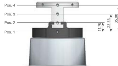
ORB-EA EINBAU IP 55 MIT VORGESETZTEM SCHUTZGLAS,
